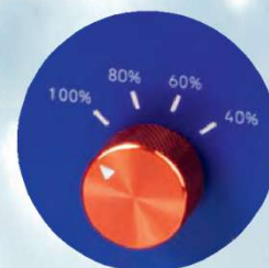
Réglage de la puissance ultrasonore : 40% / 60% / 80% / 100%
